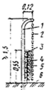
Рис. 6. Ограждение места для толкания ядра (размеры 1 метрах)
