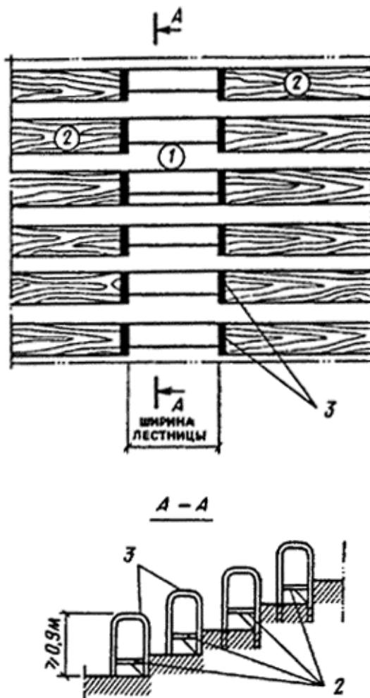
Рис. 16. Схема устройства поручней на лестницах трибуны
