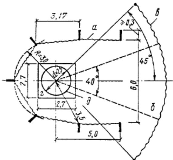
Рис. 7. План места для метания диска в сетку (размеры в метрах)
