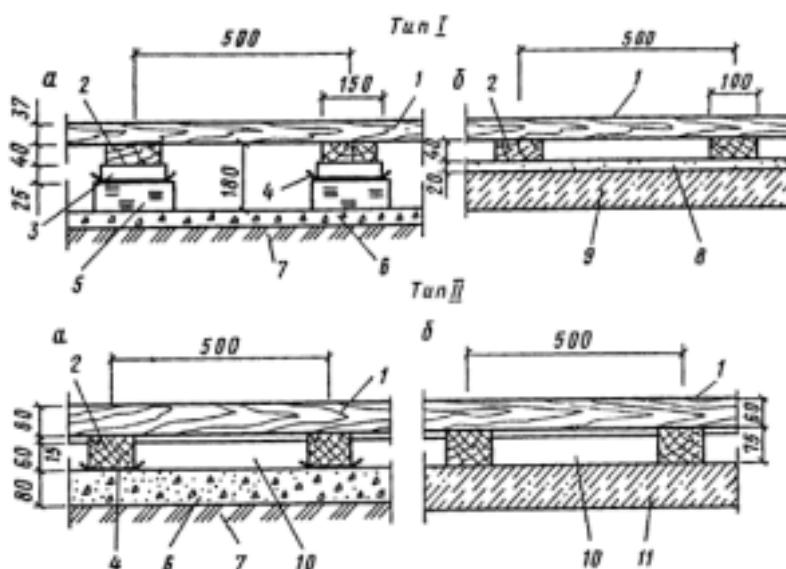
Рис. 4. Схемы конструкций деревянных полов (размеры в миллиметрах)
