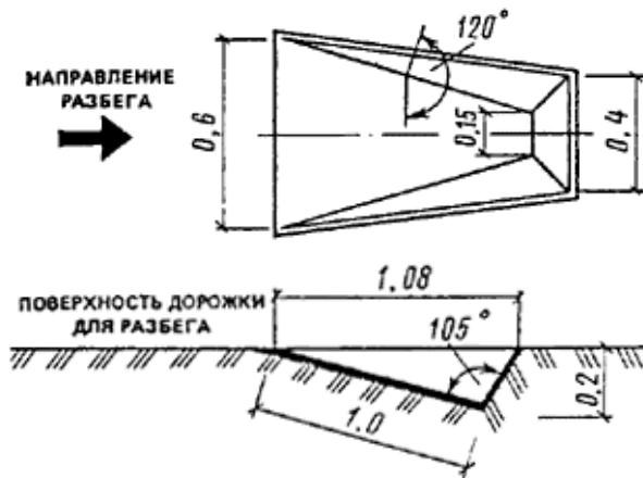
Рис. 4. Ящик для упора шеста (размеры в метрах)
