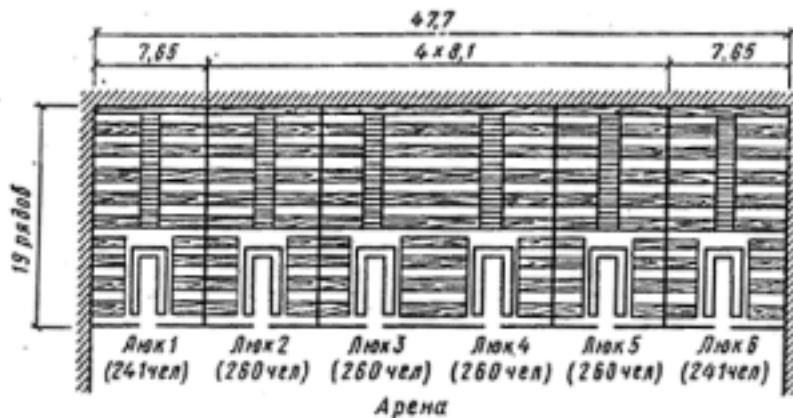
Рис. 13. Схема размещения эвакуационных люков на отметке пола аренды (размеры в метрах)
