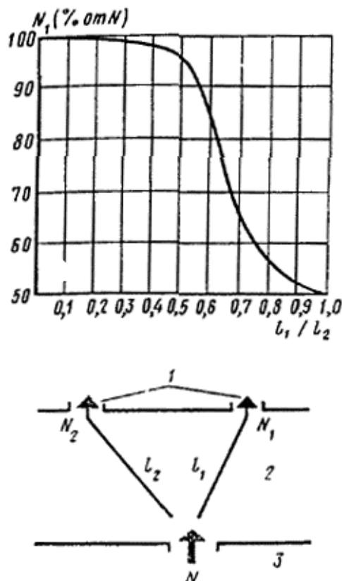
Рис. 7. Определение числа зрителей в раздельных потоках при эвакуации в две лестничные клетки, в две открытые лестницы или в два выхода из здания
