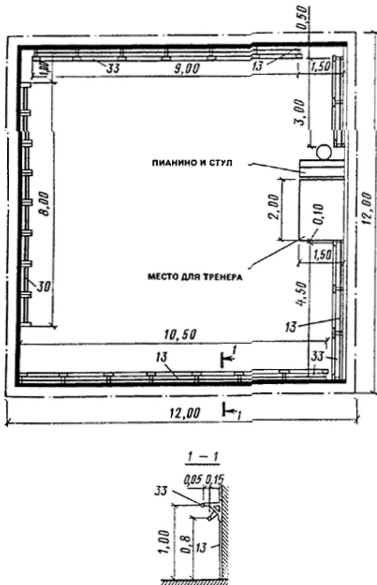
Рис. 9. Схема плана расстановки оборудования в хореографическом классе (размеры в метрах)
