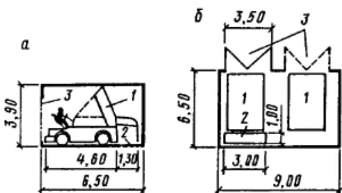
Рис. 12. Схема помещения для стоянки машин по уходу за льдом
