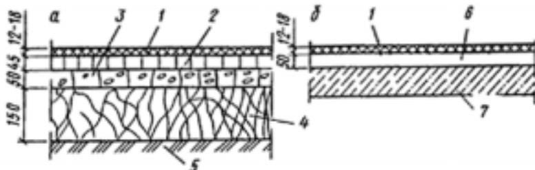
Рис. 6. Схема конструкции пола с синтетическим покрытием
