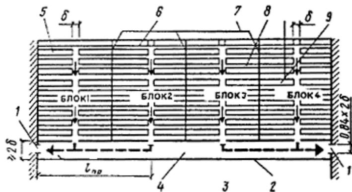
Рис. 3. Схема путей эвакуации с трибуны в общий проход
