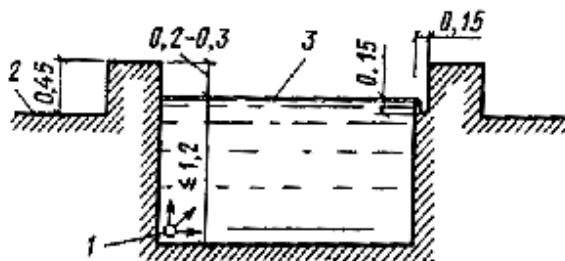
Рис. 9. Схема контрастной ванны при бане сухого жара
