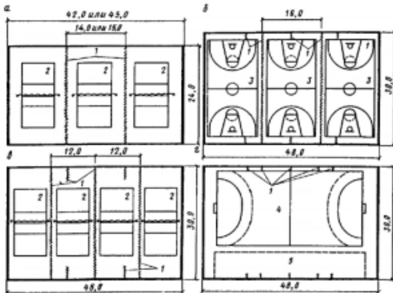
Рис. 2. Варианты схем планов деления залов на секции
