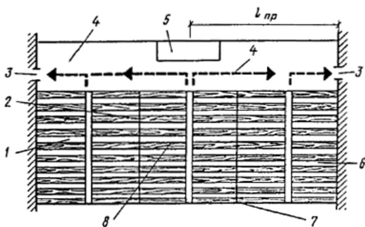
Рис. 5. Схема путей эвакуации из партера в общий проход
